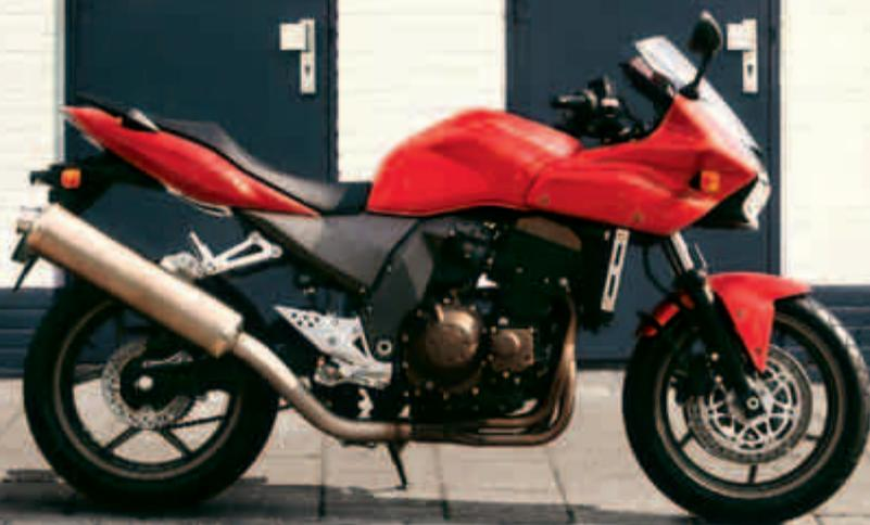
748cm<sup>3</sup> • 4 cylindres à refroidissement liquide • 4 temps avec injection d'essence électronique • 110 ch à 14 000 t/min
